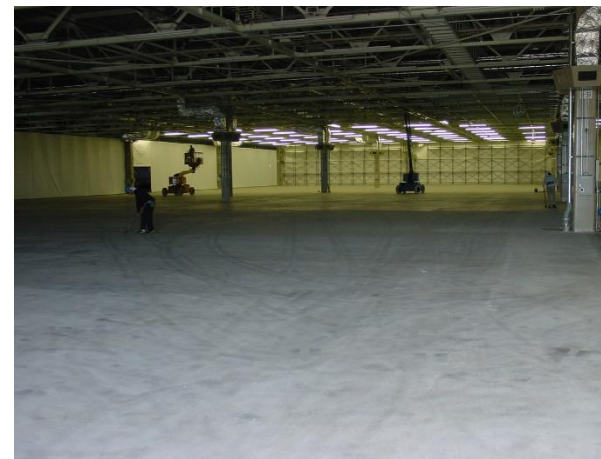
■ 工事名:自動車部品工場新築工事(田原) ■ 施工年:2002年 ■ 施工場所:愛知県 ■ 施工数量:36,770㎡ ■ 目的:コンクリート床表面強化・耐油性(艶ありタイプを使用)
