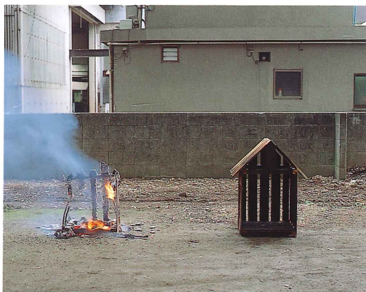
左側は完全燃焼、右側は焦げただけで原形をとどめている。
