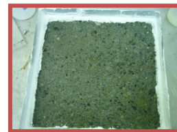
スケーリング試験終了 無処理
