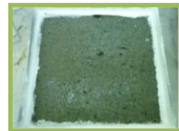
スケーリング試験終了 クリスタル床版防水工法
